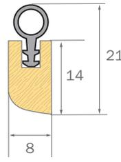
Holzprofil mit Dichtung SP0070 (Stange 2,10 m)
