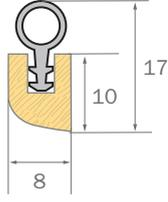
Holzprofil mit Dichtung SP0071 (Stange 2,10 m)
