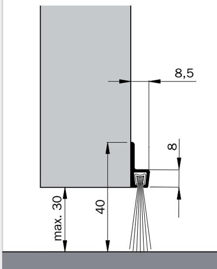
Türbodendichtung aus Stahlblech mit einem **Besatz aus Mähnenhaar**
