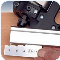
Feineinstellung der Frästiefe nach Einstelllehre.
